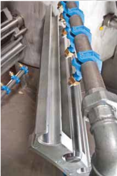
Reinigungsdüsen im Putsch® Messerkasten-Waschautomaten MWA 2200
