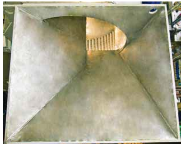
Rübeneinfalltrichter mit großem Einlaufquerschnitt aus verschleißfestem Edelstahl Beet inlet funnel with a large intake cross-section of wear-resistant stainless steel
