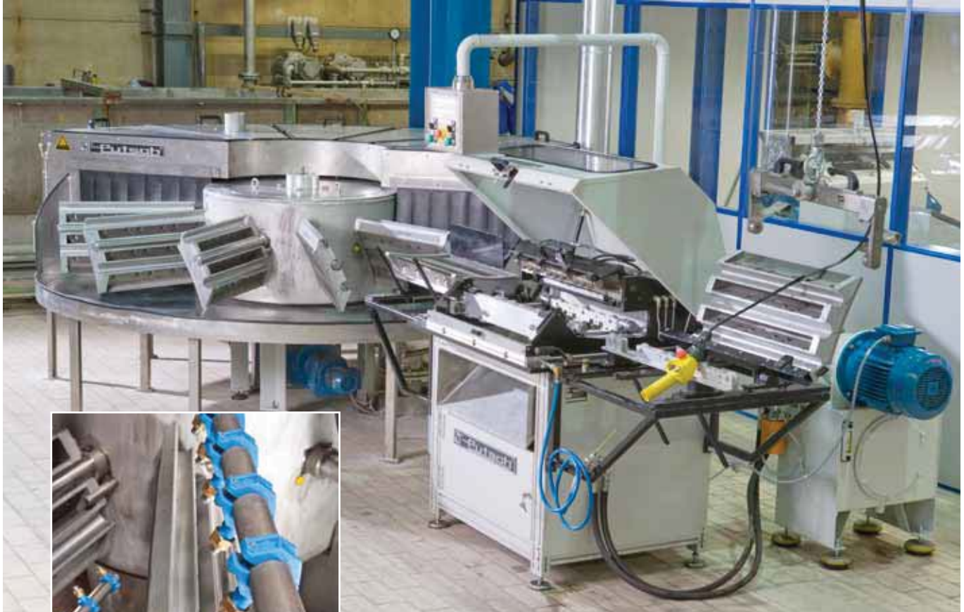
Putsch® Messerkasten-Bestückungsautomat MBA 2200 in Kombination mit dem Putsch® Messerkasten-Waschautomat MWA 2200
